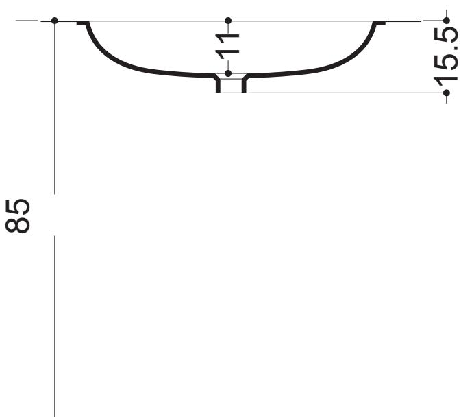
N.B.: Le misure indicate possono subire una variazione dello 0,8 % circa, dovuta ad usura stampi o a piccole variazioni delle caratteristiche tecniche relative alle materie prime che compongono l' impasto.
